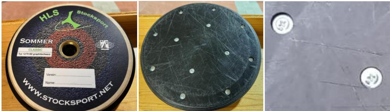
**Diese Schrauben entsprechen nicht den Richtlinien der IFI und dürfen für diesen Zweck nicht verwendet werden.** Anstelle von Einwegschräuben dürfen außerdem Kreuzschlitz-, Torx- oder Innensechskantschrauben (allesamt in der Ausführung als Senkkopfschrauben) von den Herstellern eingesetzt werden.
